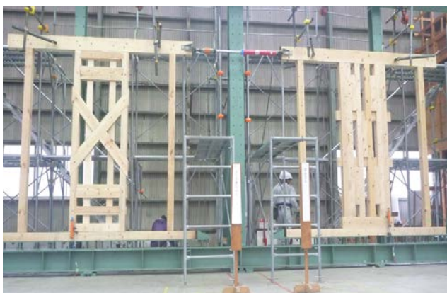
図4 木造耐力壁ジャパンカップ™の対戦例(滋賀短期大学校 VS 東日本パワーファスニング)
