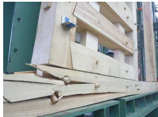
図5 土台部の込栓による割裂
