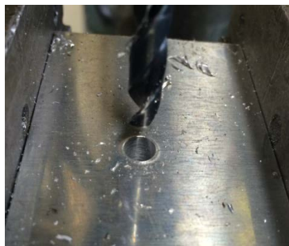
図7 研削したドリルによる穴あけ加工
