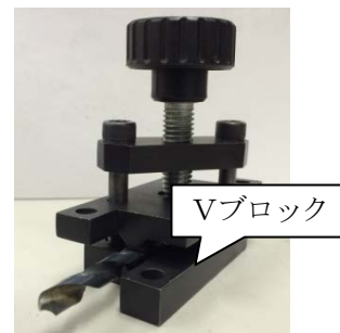
図3 黒染め処理をしたドリル取付部
