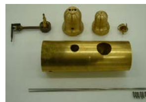
図 10. スロットル・安全弁他部位
