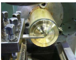
図 5. 煙室前板加工
