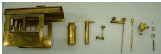
図 8. 運転室製作部位
