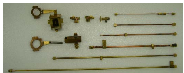
図 4. 潤滑油・給水ポンプ/配管部位
