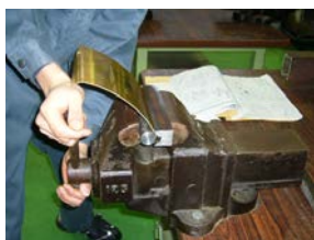
図 7. 運転室屋根加工
