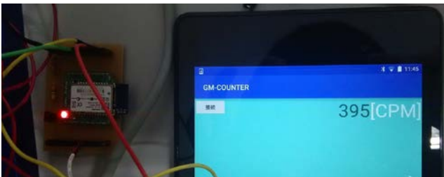
図 4 Bluetooth® モジュール (左) とスマートデバイスの無線通信の動作例
